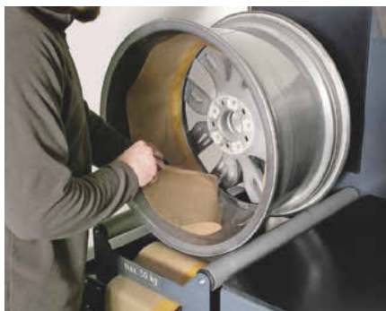
Das Abkleben wird mit dem Wheelworker leicht und schnell gemacht: Auf zwei Rollen lässt sich das Rad mühelos bewegen. Abdeckpapier und Klebeband befinden sich in direkter Griffweite.
