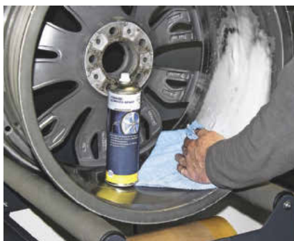
Durch die Rotationsbewegung ist auch die Reinigung der Felgen in mindestens der Hälfte der herkömmlichen Zeit machbar.
