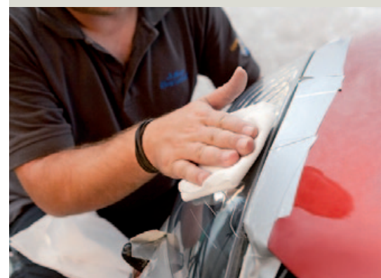
... und zum Schluss wird noch der Keramik-UV-Langzeitschutz aufgetragen.
