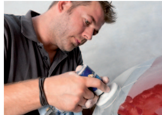
Augenwischer: Zuerst schleift der Fachmann die beschädigte UV-Schicht ab ...
