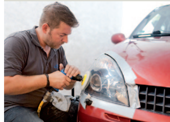
... danach erfolgt das Aufpolieren der bearbeiteten Kunststoffoberfläche ...
