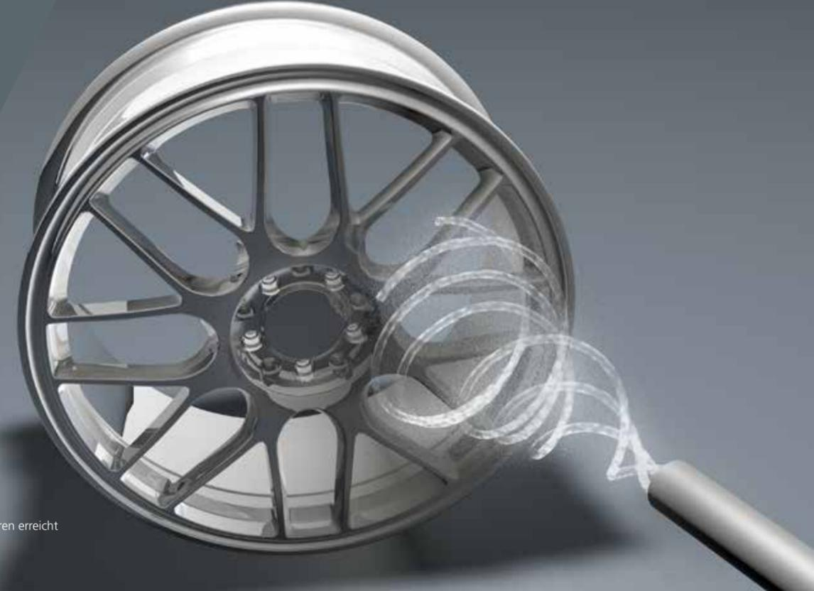
Das Wirbelstrom-Rotationsverfahren erreicht mühelos alle Ecken und Kanten
