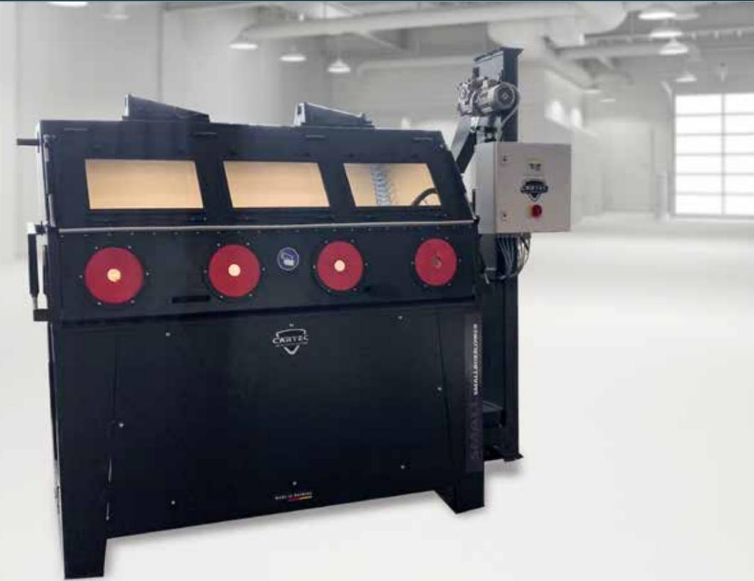
Der WheelBlower WB2000 von CARTEC ist die ideale Lösung für präzises und effizientes Oberflächenmattieren kleiner und mittelgroßer Bauteile. Die Innenkabine ist 2,00 x 1,00 Meter groß, bietet viel Platz für eine hohe Varianz an Bauteilen und ist damit bestens geeignet für Handwerk- und Industriekunden. Neben speziellen Aufnahmen für Alufelgen lässt sich die Anlage auch mit diversen Durchschiebeoptionen und weiteren optionalen Features ausrüsten.
