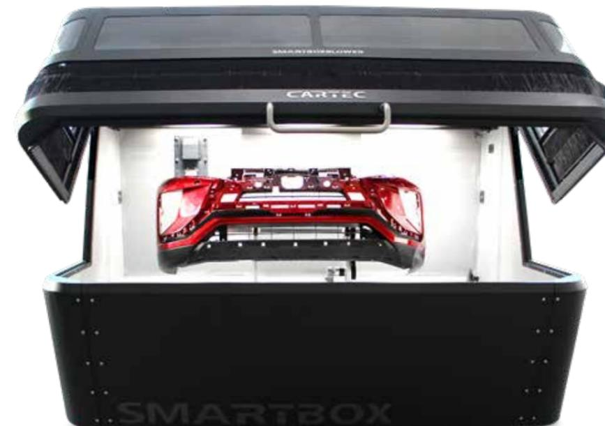
Das innovative Rotations-FLEX-System ist eine der herausragenden Eigenschaften des SmartBoxBlowers. Erstmals ist es dem Anwender möglich, ohne Schutzanzug außerhalb der Kabine zu stehen und die Stoßfänger so zu rotieren, dass diese ringsum und von „Ohr zu Ohr“ geblowert werden können.
