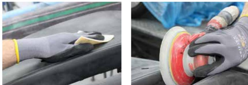
Schleifen, schleifen, schleifen. Bei der händischen Lackiervorbereitung gehen jede Menge Zeit, Nerven und Material drauf. Gerade in engen Zwischenräumen und bei komplexen Designs
