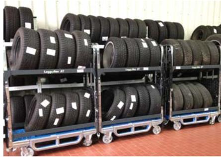
Am Fahrzeug entnimmt der Monteur die vorbereiteten Räder, montiert direkt am Auto und füllt das leere Regalfach mit den abgeschraubten Rädern auf. Dabei kann ein Wheel-Mover bis zu 10 Reifen der Größe 195 aufnehmen oder 8 Räder bis zu einer Breite von 235 mm. Er trägt bis zu 260 kg, also auch große bzw. schwere Radgrößen.
