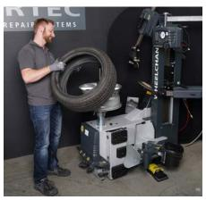
Mit dem WheelChanger aus der WheelMaster-Familie des schwäbischen Felgenspezialisten CARTEC können sowohl (L)LKW- als auch PKW-Reifen sorglos und vor allen Dingen schadenfrei montiert werden. Vollautomatisch und ohne Montiereisen. Die Bedienung erfolgt über ein Steuerpult mit Ein-Hand-Joystick. Mit dem integrierten Radlift gelangen die schweren Räder ohne Kraftaufwand auf die Mittenzentrierung. Dort werden sie über ein drehbares, selbstzentrierendes Spannfutter verspannt.
