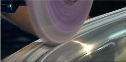
Rotationsschleifverfahren: Die sich drehende Felge und Schleifscheibe sowie Lage und Neigung der Felge auf der Maschine machen das präzise Arbeiten erst möglich.
